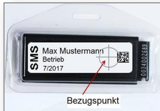
Die Vorzugsrichtung für den Strahleneinfall ist senkrecht von vorn auf die Detektoroberseite, wobei sich der Bezugspunkt mittig links neben dem 2D-Code befindet.
