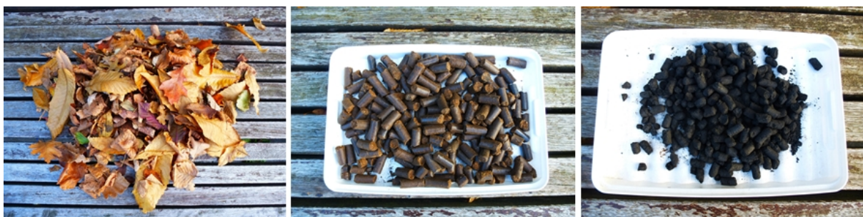
Abbildung 18 Laub (links) wird über Verdichtung zu Laubpellets (mitte) und mittels Karbonisierung zu Pflanzenkohle (rechts) (Bilder: Wagner et. al., 2019)
