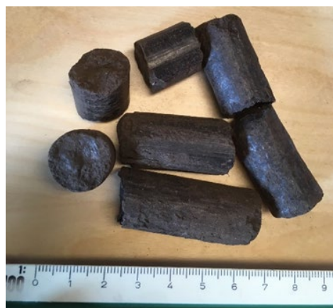
Abbildung 10 Graspellet für den Förderversuch im Kraftwerk Moabit – Vattenfall (Bild: ICU)
