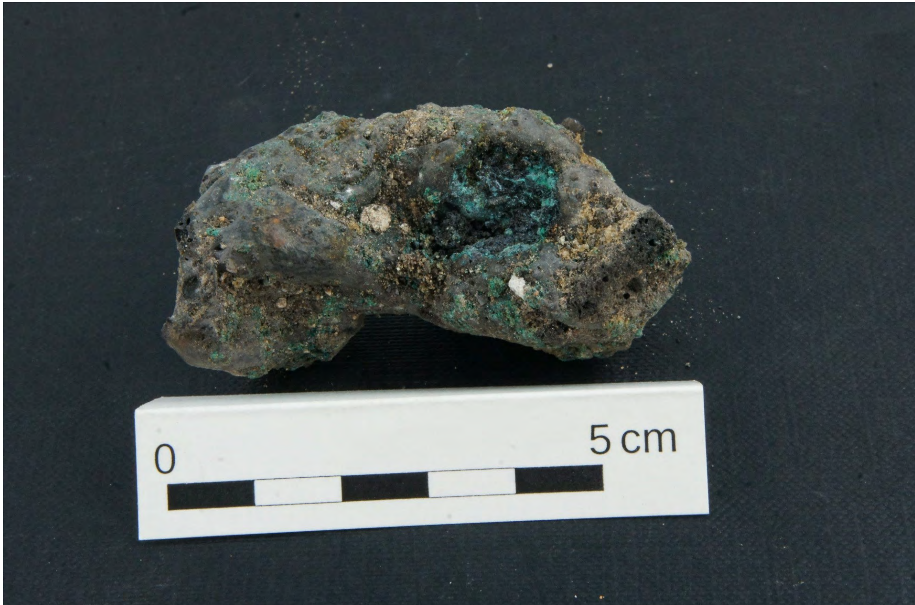
Abbildung B-17: Kupferhaltige Schlacke, Foto: V. Kinlechner (Geographisches Institut, Humboldt-Universität zu Berlin)
