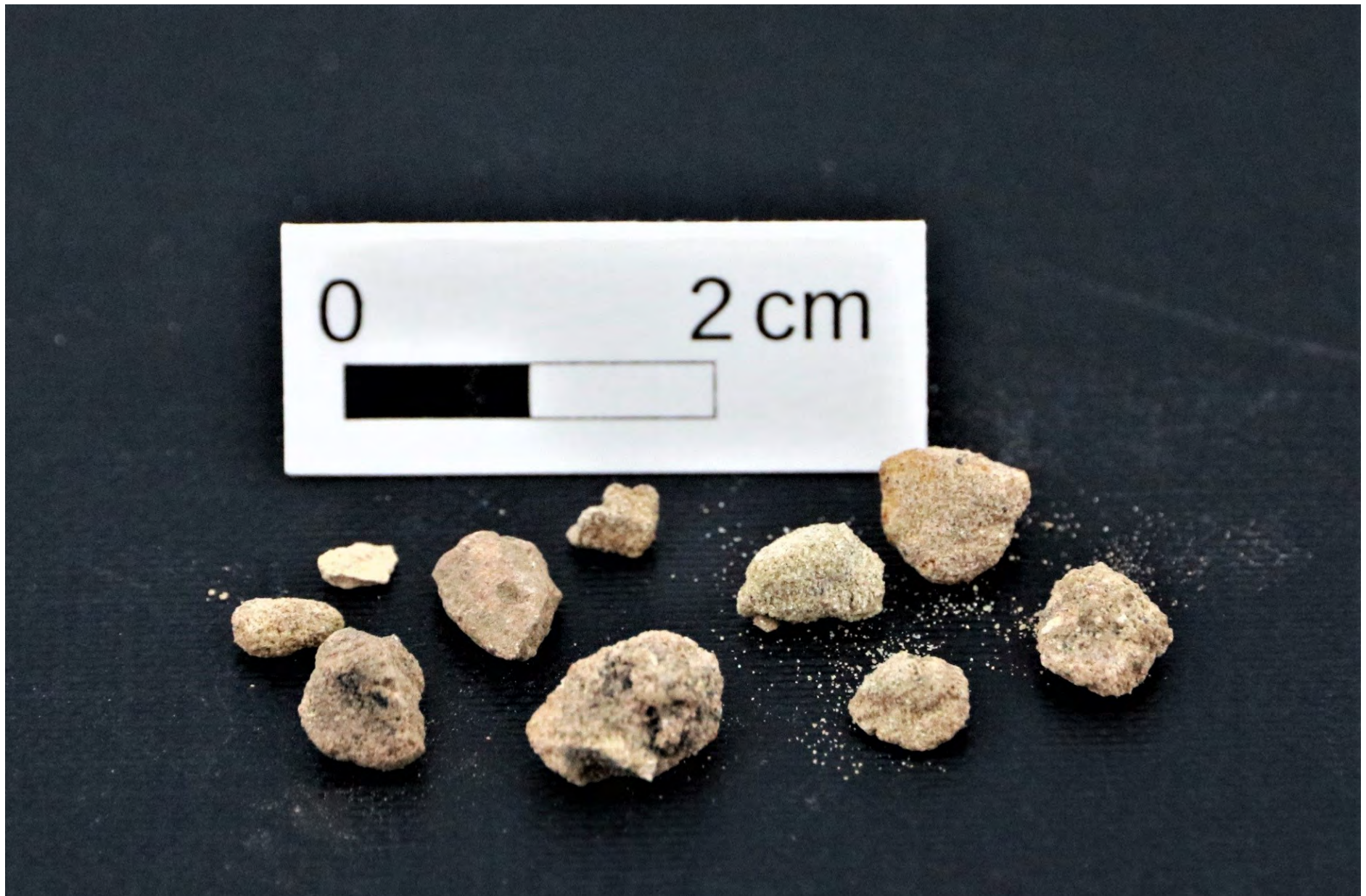
Abbildung B-20: Stark verwitterte Mörtelreste, Foto: V. Kinlechner (Geographisches Institut, Humboldt-Universität zu Berlin)
