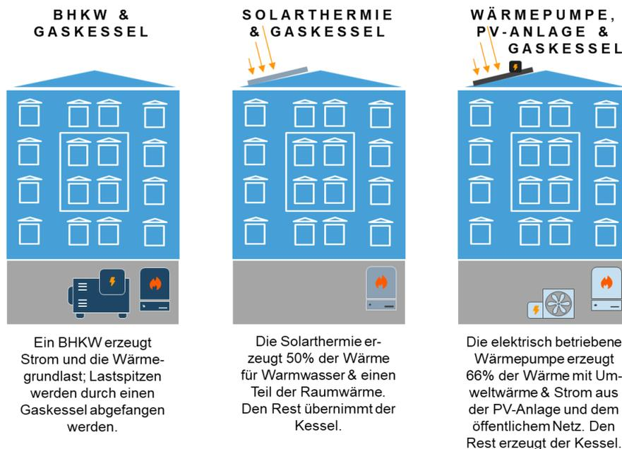
Abbildung 9: Übersicht über die definierten dezentralen Versorgungsoptionen für eine Altbau und einen Neubau
