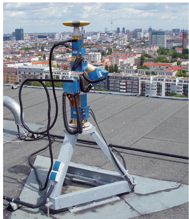
Abb. 5: Dach des Dienstgebäudes Württembergische Straße, Zentrale SAPOS Berlin und Antennenkalibriereinrichtung
